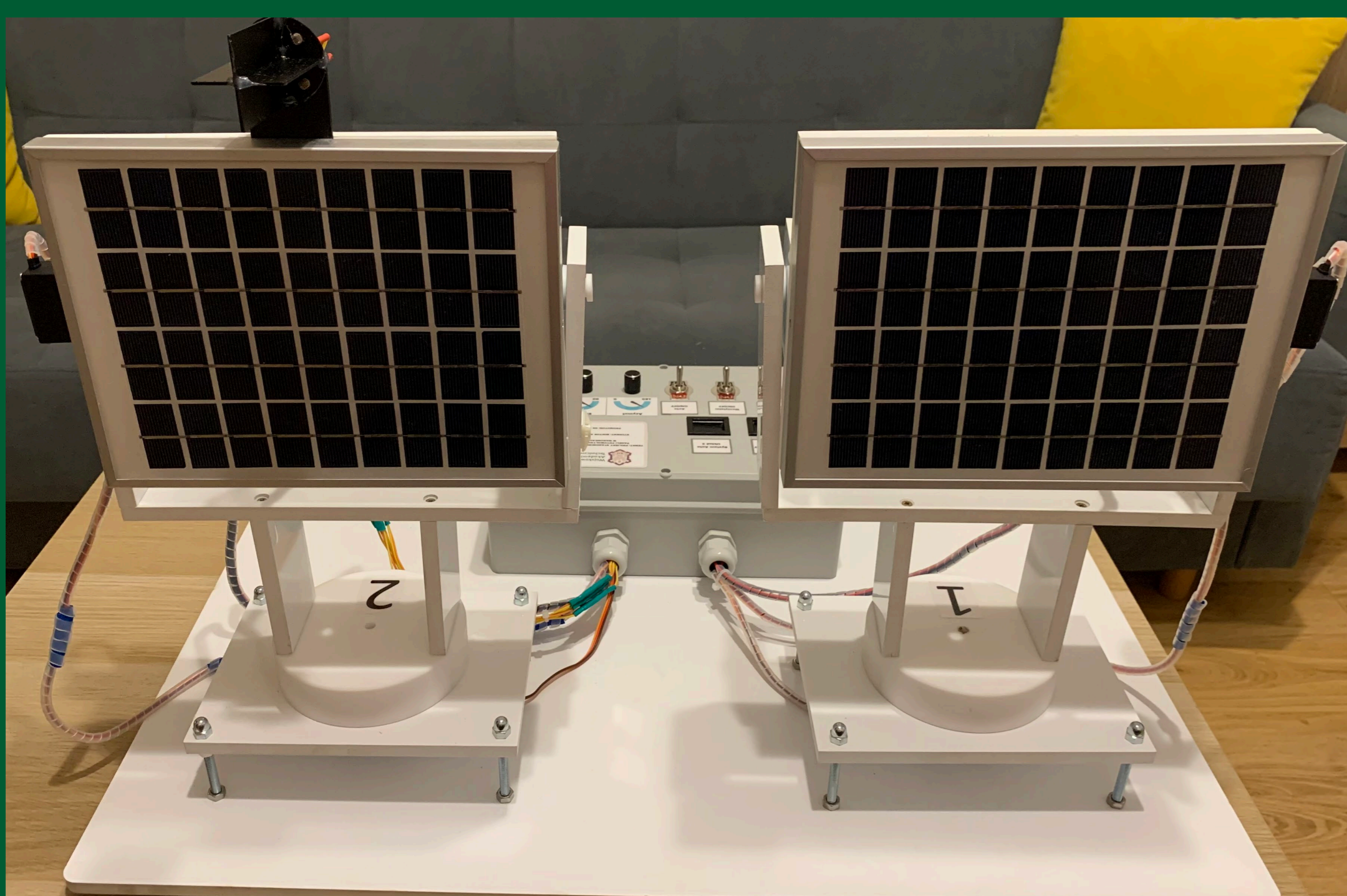
Rys. 1. Stanowisko do prowadzenia badań paneli fotowoltaicznych w warunkach rzeczywistych (Rzut przedni).
