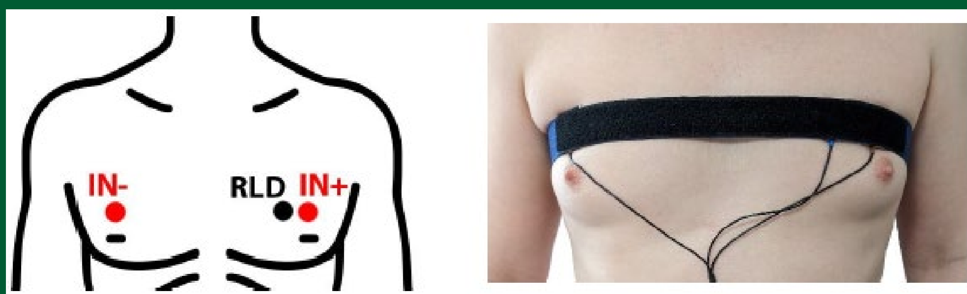
Rys. 1. Schemat i przykład praktyczny montażu opaski pomiarowej na klatce piersiowej
