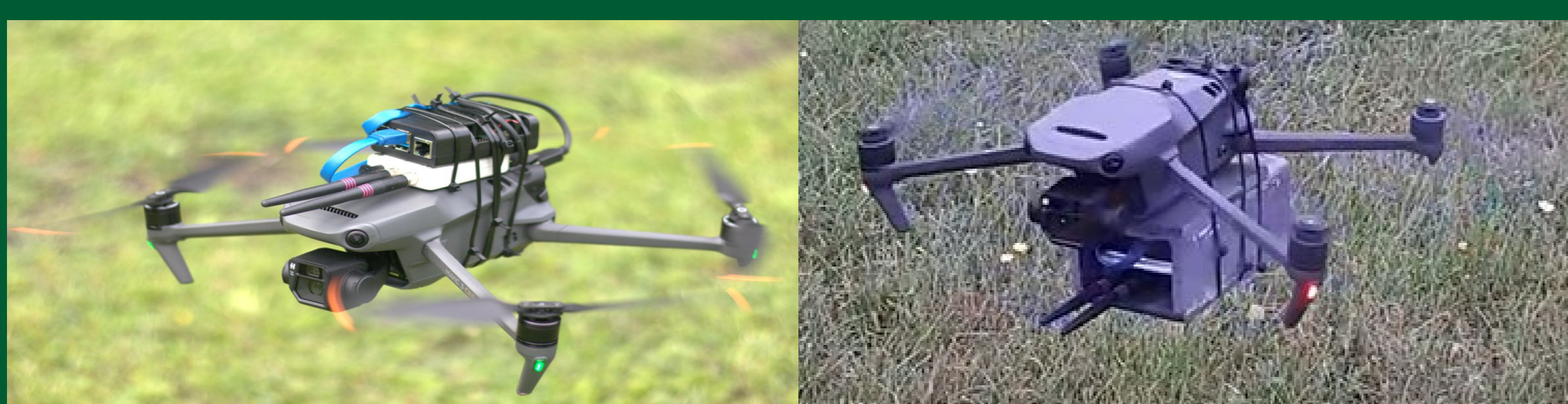
Rys. 1. Bezzałogowy Statek Powietrzny z układem zakłócającym zasilanym z drona (po lewej) oraz wykorzystaniem PiJuice (po prawej)
