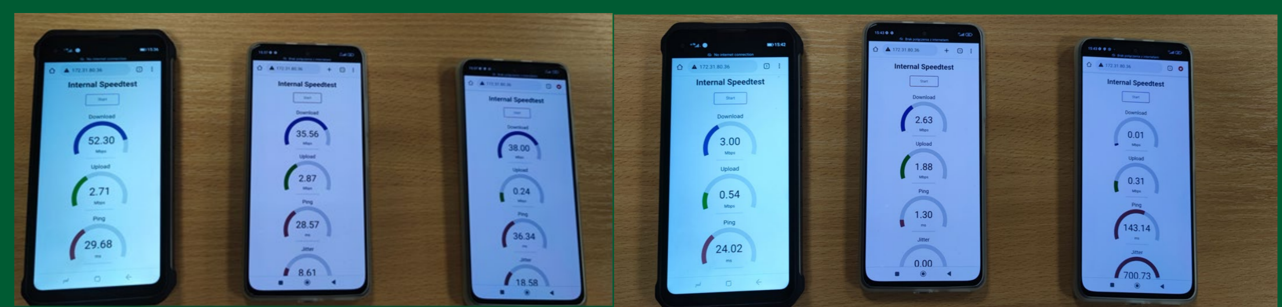
Rys. 3. Porównanie parametrów jakościowych łącza downlink i uplink sieci 5G bez zakłócania z aktywnym sygnałem zakłócającym
