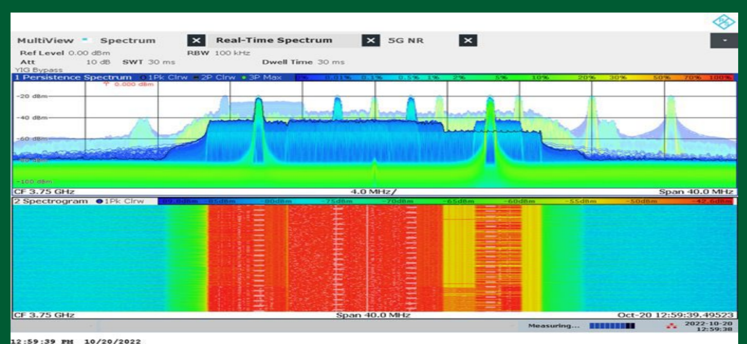
Rys. 2. Zakłócanie stacji bazowej 5G sygnałem OFDM wykonanym metodą przestrojenia częstotliwości środkowej o 0,1 sekundy
