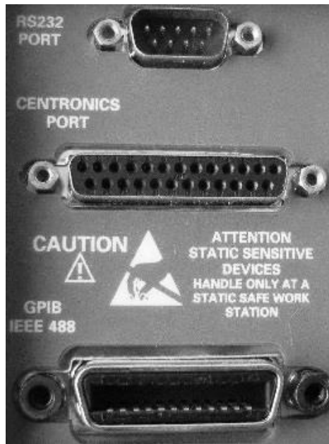
Rys. 9.3. Panel tylny oscyloskopu ze złączami interfejsów
